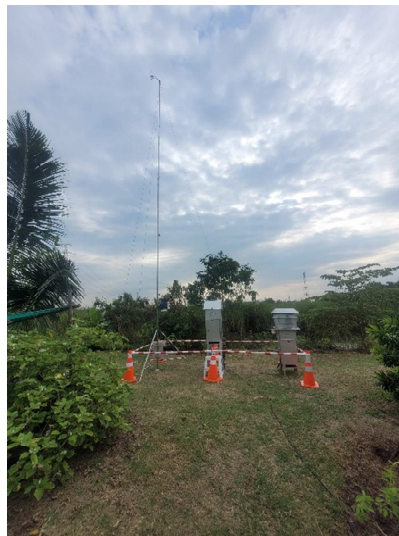
รูปที่ ค-80 การตรวจวัดคุณภาพอากาศในบรรยากาศโดยทั่วไป บริเวณกลุ่มบ้านพักอาศัยใกล้เคียงพื้นที่ก่อสร้างสถานี MR ระหว่างวันที่ 20-24 ตุลาคม 2565
