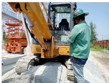
รูปที่ ค-61 ตรวจสอบสภาพรถขุดก่อนเริ่มปฏิบัติงาน
