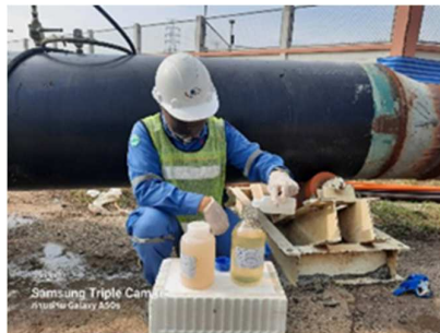
รูปที่ ค-26 ทำการตรวจสอบคุณภาพน้ำ ก่อนปล่อยทิ้งลงสู่แหล่งน้ำ
